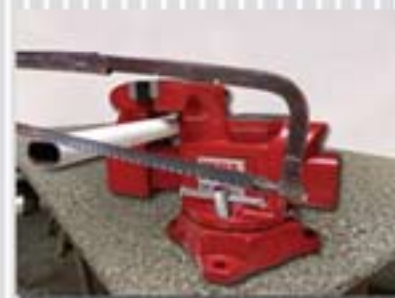
Prensa de tubos para diferentes calibres
