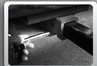
Insertar la lengüeta dentro del tirón
